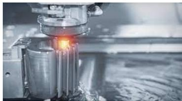
Électroérosion par fil et par enfonçage
